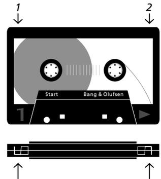
*Der Streifen links ermöglicht Aufnahme auf Seite 1 (A), während der Streifen rechts Aufnahme auf Seite 2 (B) ermöglicht.*
