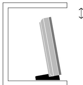
Zur Sicherung ausreichender Ventilation des Systems muß über dem System und an den Seiten 5 cm Luft sein.
