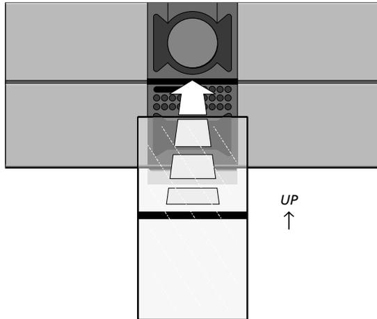
Ihr BeoSound Century System kann stehend im Sockel am Fußboden, in einem Regal oder auf einem Tisch aufgestellt werden - oder es kann mittels der Wandkonsole (wahlfreies Zubehör, Typennr. 2088) an die Wand gehängt werden. Die Installation der Wandkonsole ist im Abschnitt "Wahlfreies Zubehör" im einzelnen beschrieben.
